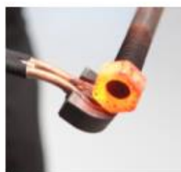
Opvarmning af rustne bolte og møtrikker
