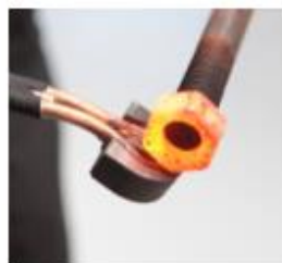
Opvarmning af rustne bolte og møtrikker
